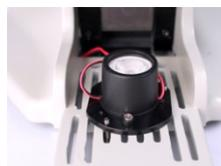
Iluminação de LED com ajuste de intensidade
